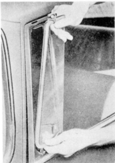
Fig. 10-20 Removing Vent Door
